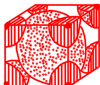
Fe Alfa y Delta (Cúbica Centrada en el Cuerpo)
